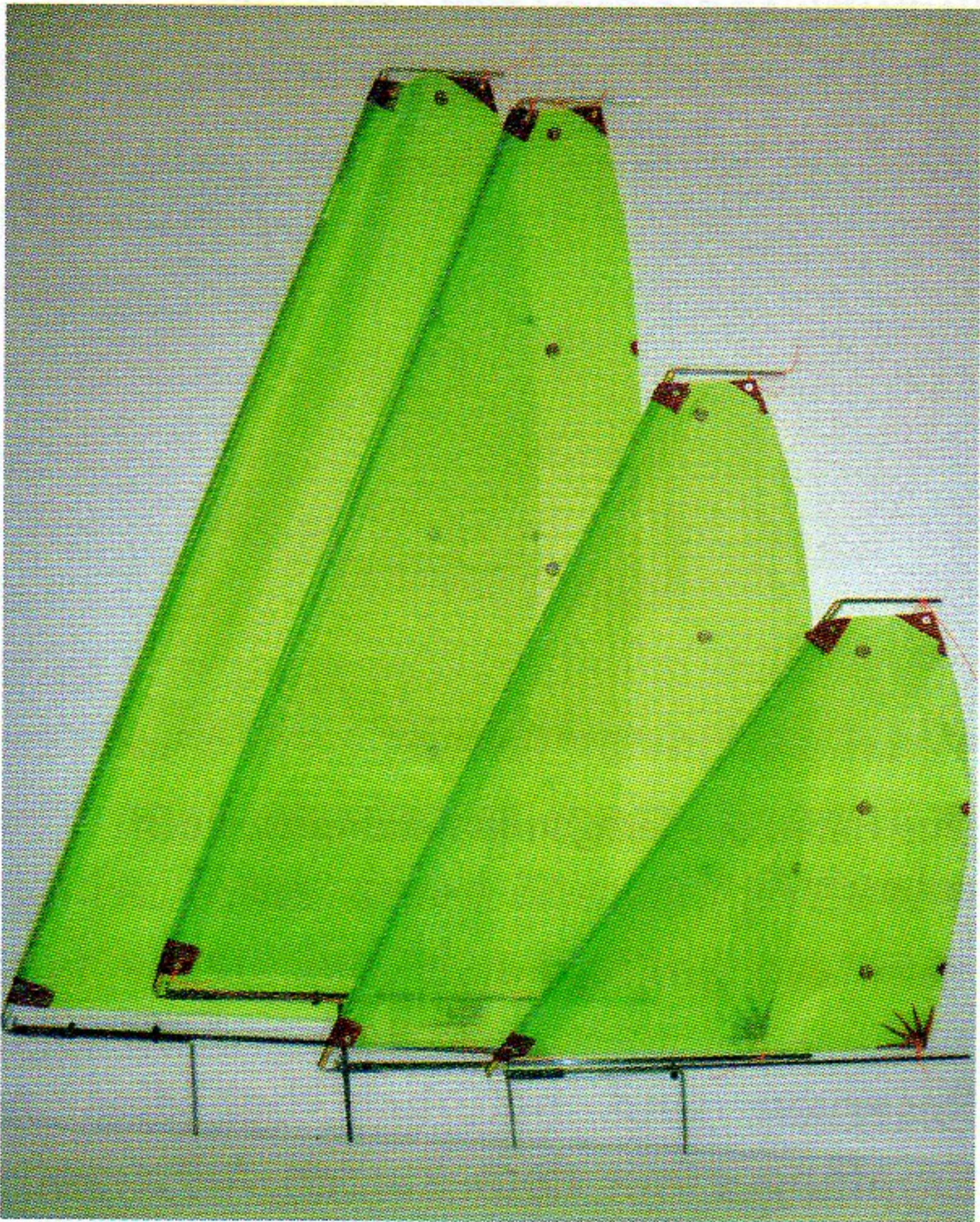
Ein Satz McRig (nach dem Erfinder Brett McCormack aus Neuseeland benannt) für eine Footy, für unterschiedlichste Windstärken (A-, B-, C- und D-Rigg)
