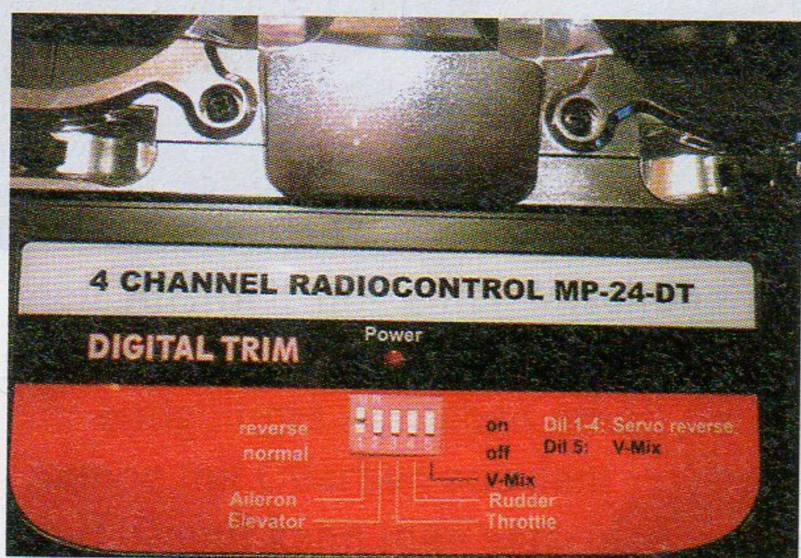
Dil-Schalter zur Einstellung der Servorichtung
